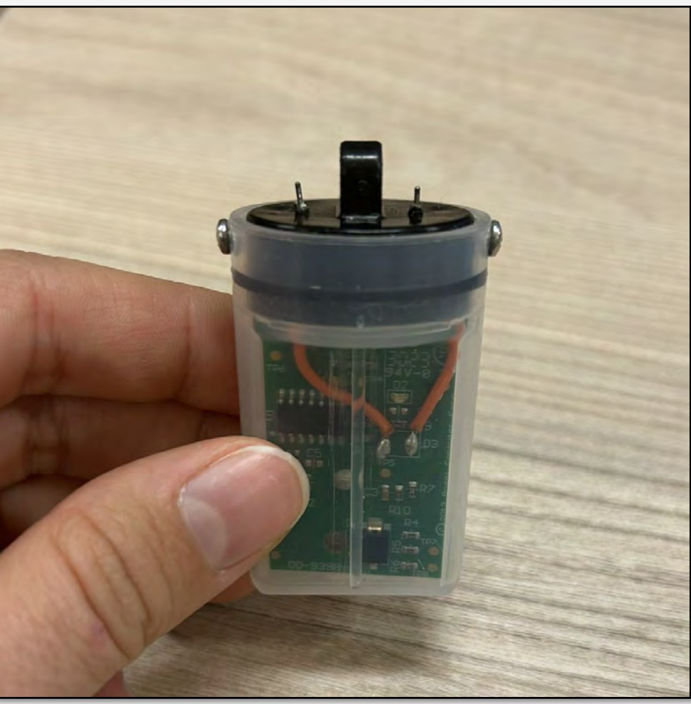
Figure 3. Capteur de mesures d'intermittence de l'écoulement et son installation dans le lit d'un cours d'eau
