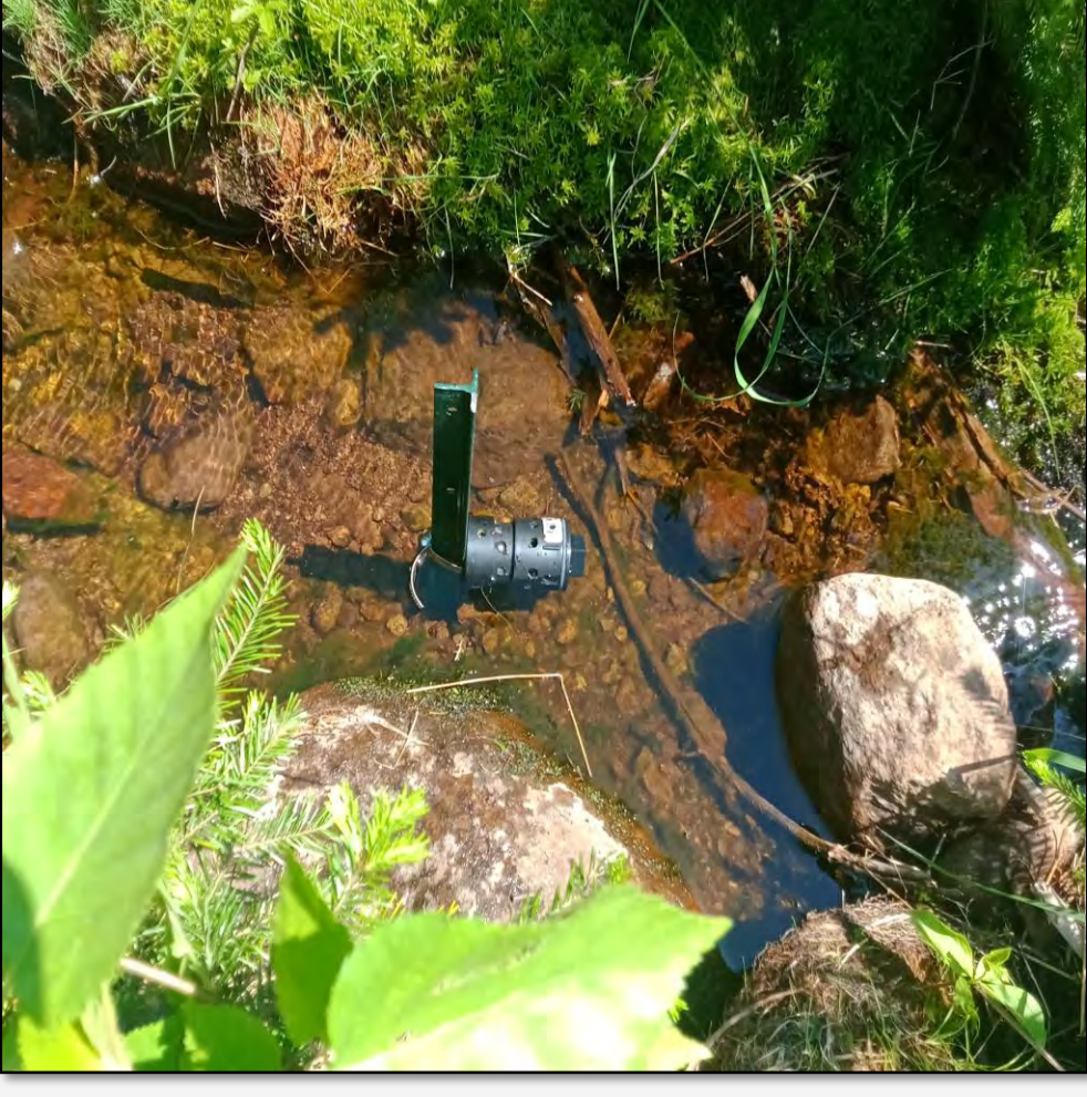
Figure 3. Capteur de mesures d'intermittence de l'écoulement et son installation dans le lit d'un cours d'eau
