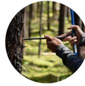
Utilisation d'une sonde de Pressler
