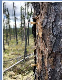
Sonde de dissipation thermique (flux de sève)
