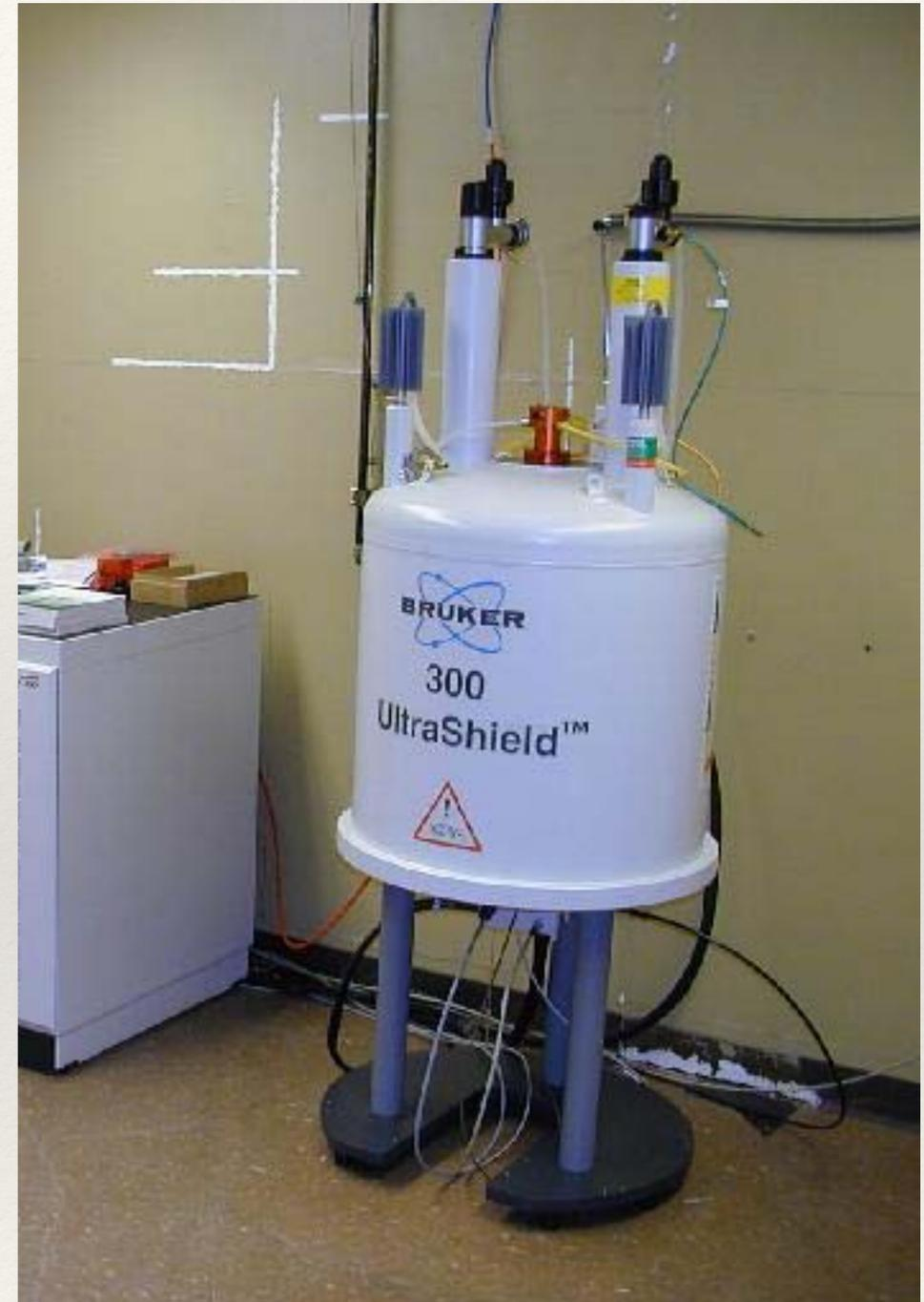
*Spectromètre - acquisition de spectres RMN*
