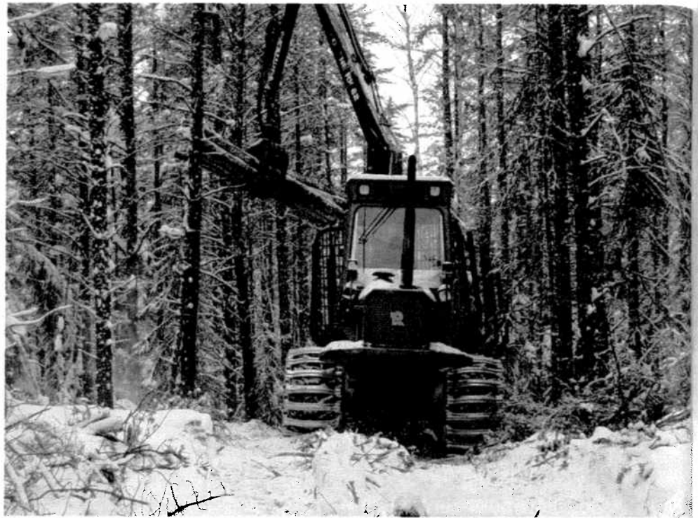
Éclaircie commerciale résineuse mécanisée en Abitibi, à l'aide d'une machine de petite dimension. Tembec
