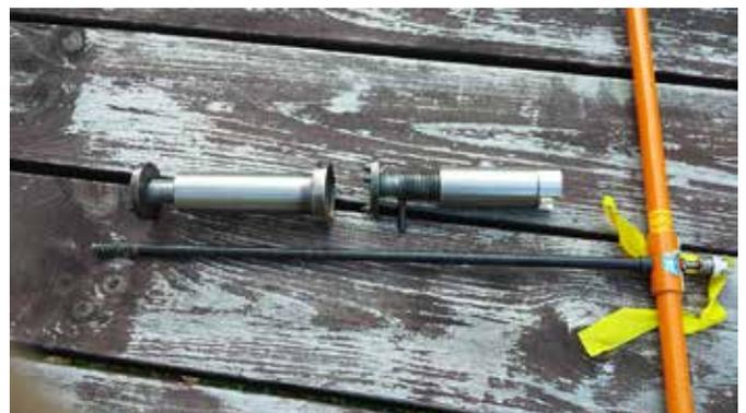
Extracteur de sonde de Pressler inventé par Laurier Groleau de la DRF. MFFP.
