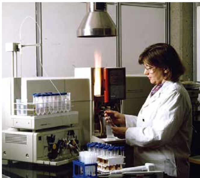
Une technicienne de laboratoire faisant l'analyse des métaux présents dans les sols par spectrométrie d'absorption atomique.
