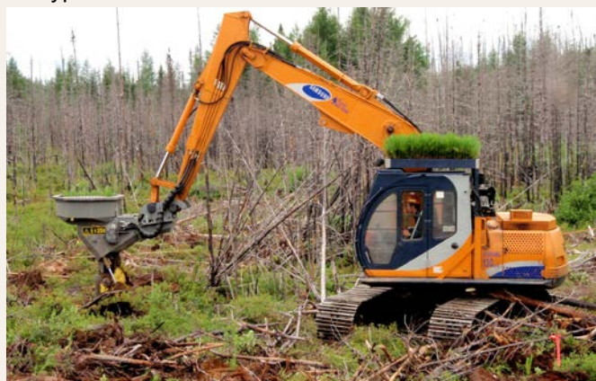
La planteuse mécanique P11a de Bracke fait une scarification par monticule avant la mise en terre.
