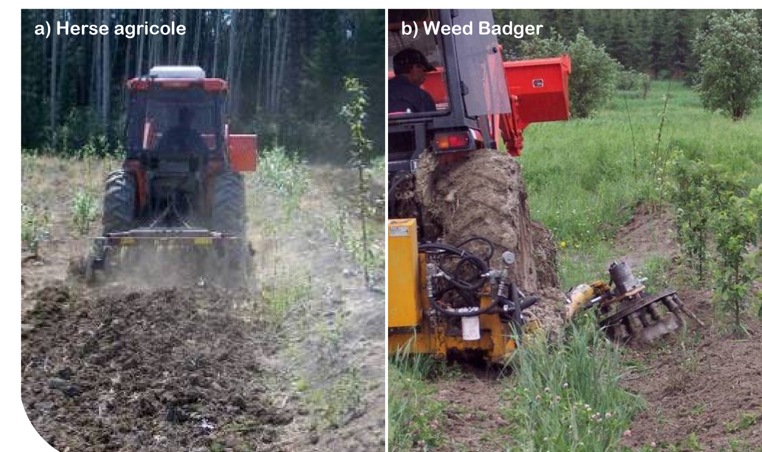
Photos 4 : Entretien mécanique de la végétation à l'aide de a) la herse agricole entre les rangs et b) à l'aide du Weed Badger sur le rang.
